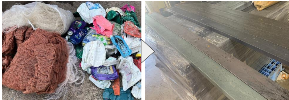
第1回渡航時にタイで回収された漁網（25%配合）およびプラスチックボトル（50%配合）より製作した板材
