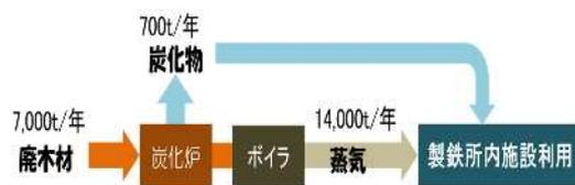
図 6 製鉄所内の蒸気供給ボイラ事例
