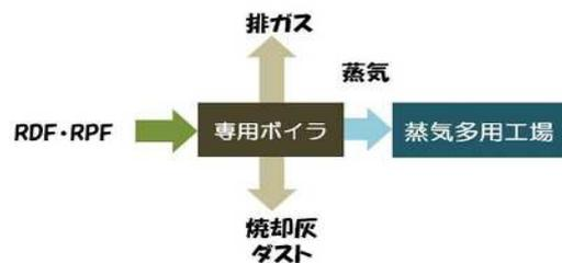
図5 蒸気供給専用ボイラ利用
