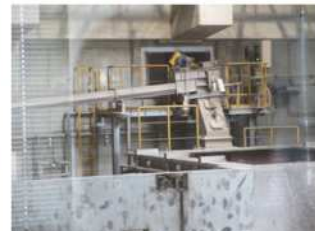
ごみ投入ホッパーに フライトコンベヤで汚泥投入
