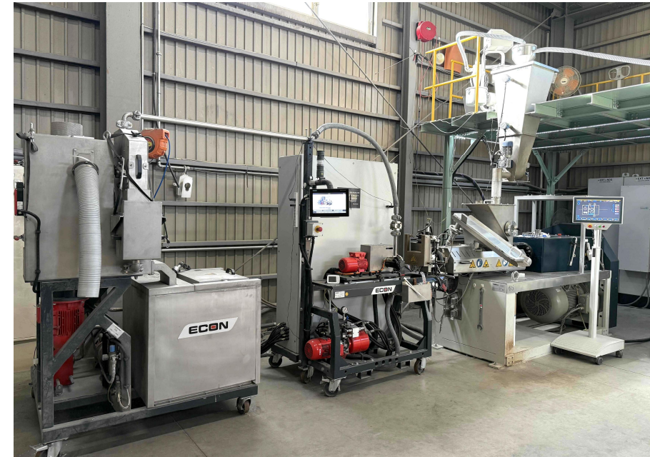
④二軸押出機+水中カットライン
