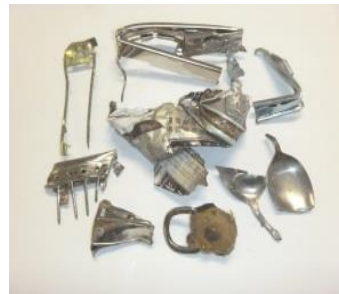
写真1 磁選分離の鉄類 写真2 風選分離の石類
