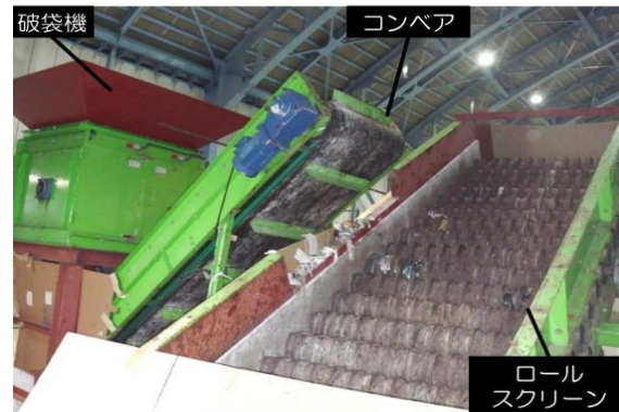
写真3 ロールスクリーン （異物除去が比較的容易）
