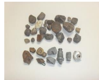
写真1 磁選分離の鉄類 写真2 風選分離の石類
