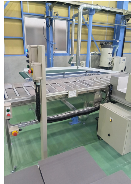
廃TCP清掃装置
