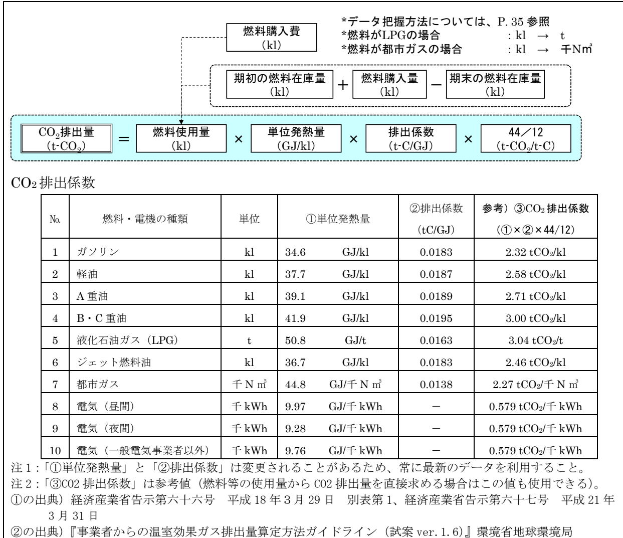
図 II-7 燃料法による CO 2 排出量算定式
