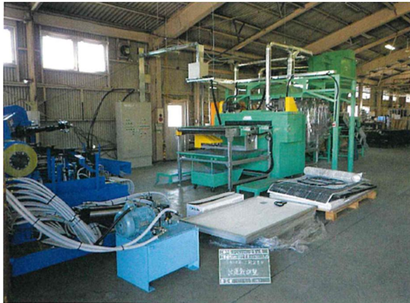
【PVエコライン】太陽光パネルリサイクル設備（ローラー圧縮式）
