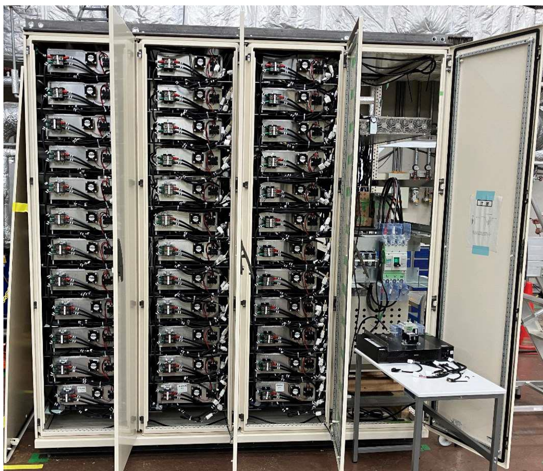
図 2.1.6 蓄電池キュービクル試作機の外観
