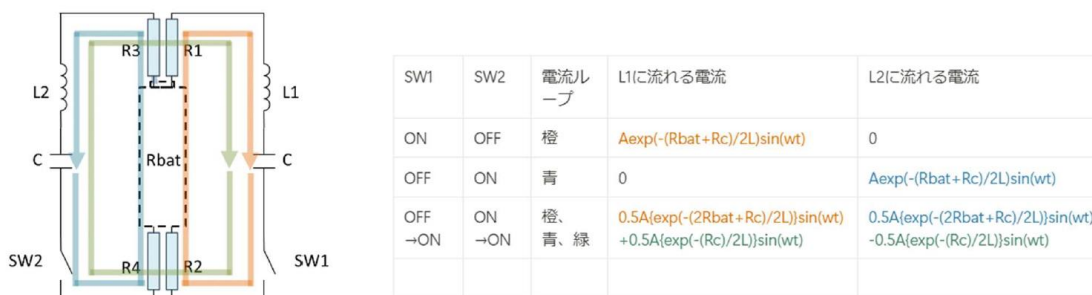
図 2.3.6 ピンプローブと電池の電極間の接触抵抗の算出法の概略図
