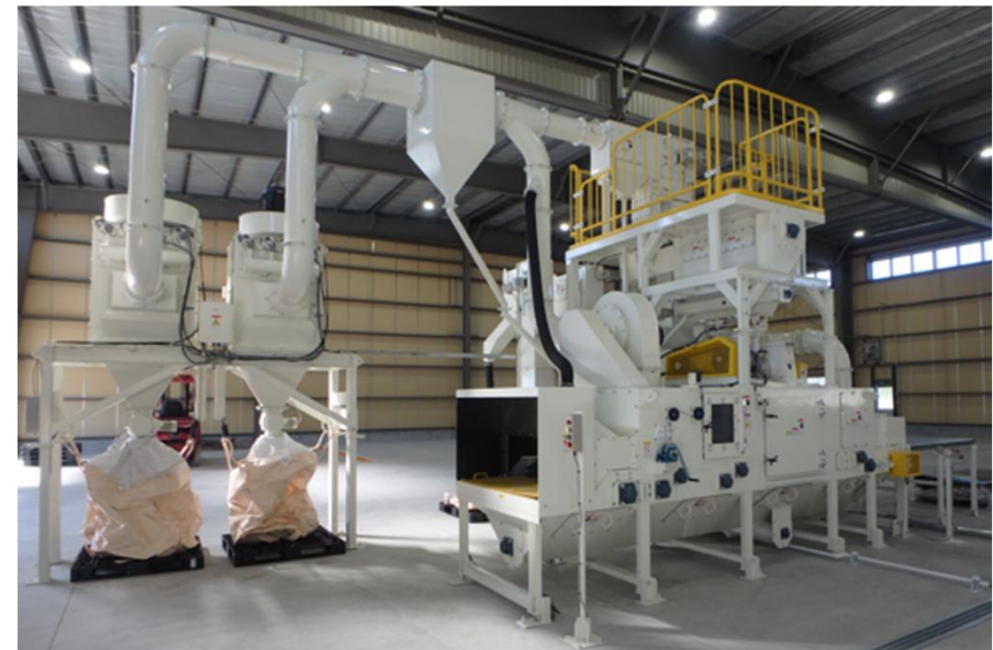
ガラス剥離設備
