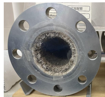
リンが結晶化 (閉塞管の原因)
