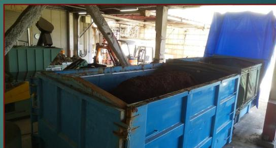
コンテナ型発酵装置
