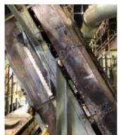
火災で焦げた破碎物コンベヤ（府中市）
