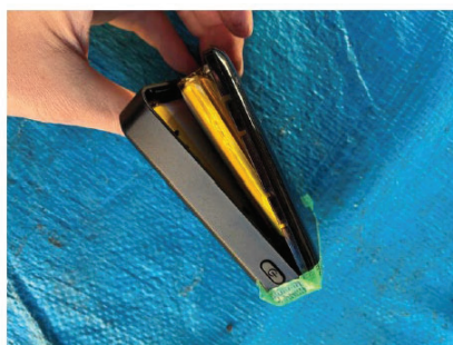
膨張したリチウムイオン電池
