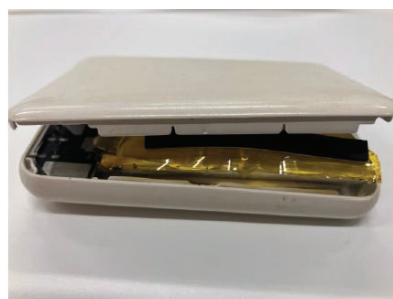
膨張したリチウムイオン電池
