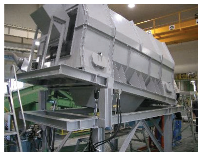
HDD 自動解体装置外観
