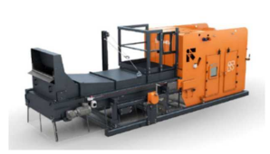
金属高度選別設備
