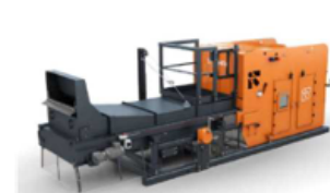
金属高度選別設備
